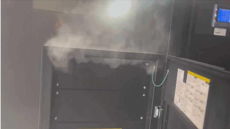
5、2022年7月21日，北京某研究院，发生一起催化剂泄漏自燃，造成1人死亡，1人受伤。事故原因：实验操作人员在实验室分装含有甲基铝氧烷（为自燃固体，属危险化学品，遇空气燃烧）的催化剂时发生泄漏，催化剂遇空气发生剧烈燃烧，导致现场操作人员伤亡。
